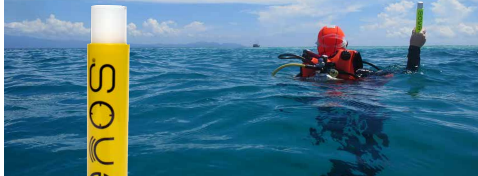
Der Enos®-Sender ist auch mit nassen Fingern und dicken (Trocken-) Handschuhen ganz leicht zu bedienen: Einfach nur den roten Schalter um 180° drehen - und schon ist er an. Er misst 20 Zentimeter in der Länge und drei im Durchmesser, wiegt nur 160 Gramm und sendet bis zu zehn Kilometer weit.
